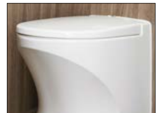
Cinderella förbränningstolett. Cinderella är en modern och miljövänlig toalettlösning med stor kapacitet och hög driftsäkerhet. Under hög temperatur förbränns papper, urin och fekalier till en minimal mängd aska, ca en kopp per person och månad. Rent, hygieniskt och luktfritt. (TDL-modeller Royal, Imperial och Hacienda)
