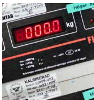
Vågar för att balansera och optimera viktfordelning mellan axlar.
