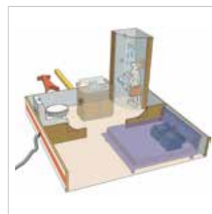
1. VA-anslutning 2. Utvärdig förlängning duschavlopp (X0201)
