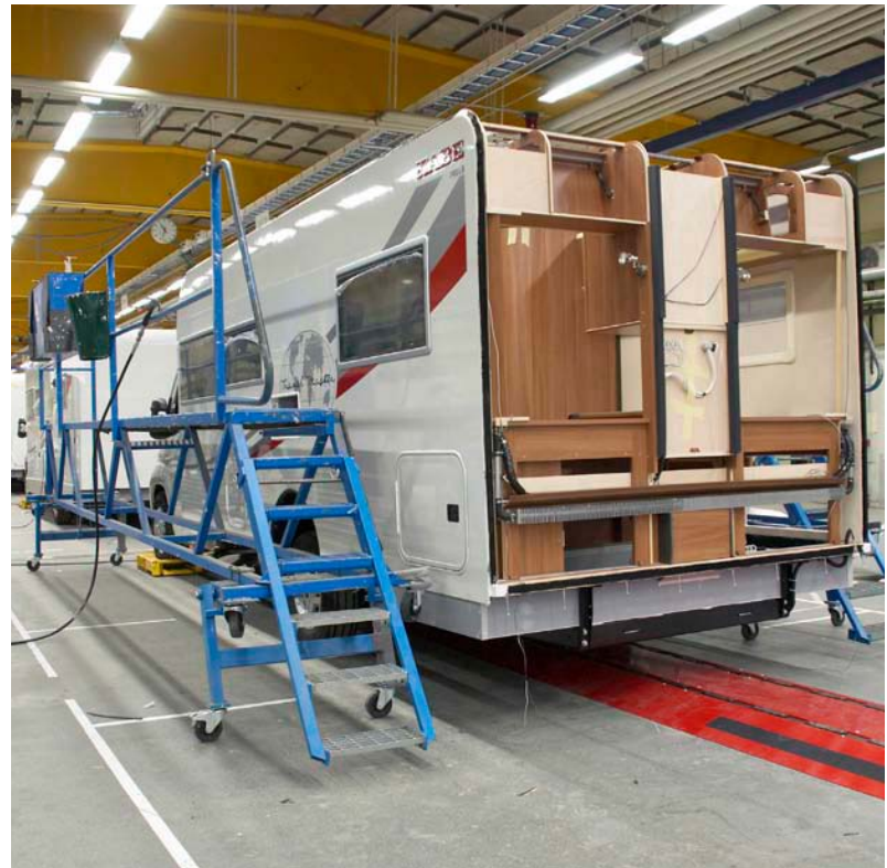
Den 102 meter långa motoriserade linan rymmer 10 bilar och hastigheten bestäms utifrån efterfrågan.
